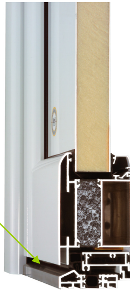
Tür-Schnitt vertikal im Sockelbereich
